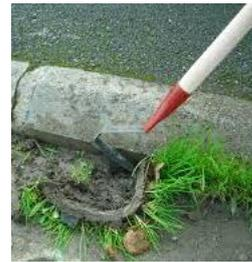
La débroussailleuse à lames réciproques de type Auxicut peut également être utile au désherbage des voiries, pieds de murs, et prairie en fauche tardive. Sa tête étanche permet également d'entretenir les berges des fossés et cours d'eau. L'outil serait utile pour l'entretien de la mare et notamment la gestion des roseaux qui vont à terme coloniser l'ensemble du plan d'eau, chose à éviter.
