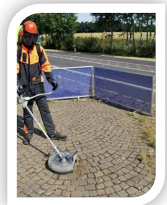
**La débroussailleuse à fil peut aussi être utilisée mais il convient d'être très vigilant au niveau des projections. Une cloche spécifique peut être adaptée.**
